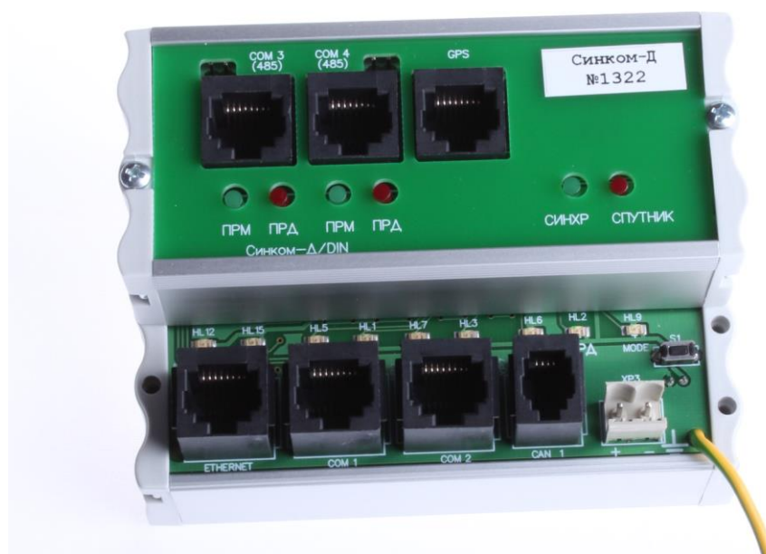
Рис. 1 Внешний вид контроллера «Синком-Д»
